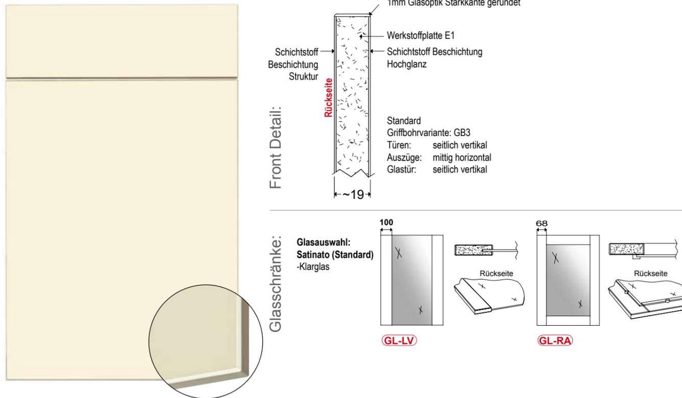
19mm E1 Werkstoffplatte mit beidseitiger Schichtstoffbelegung. 4-seitig mit 3D Glasoptik Starkkante, allseits gerundet.
