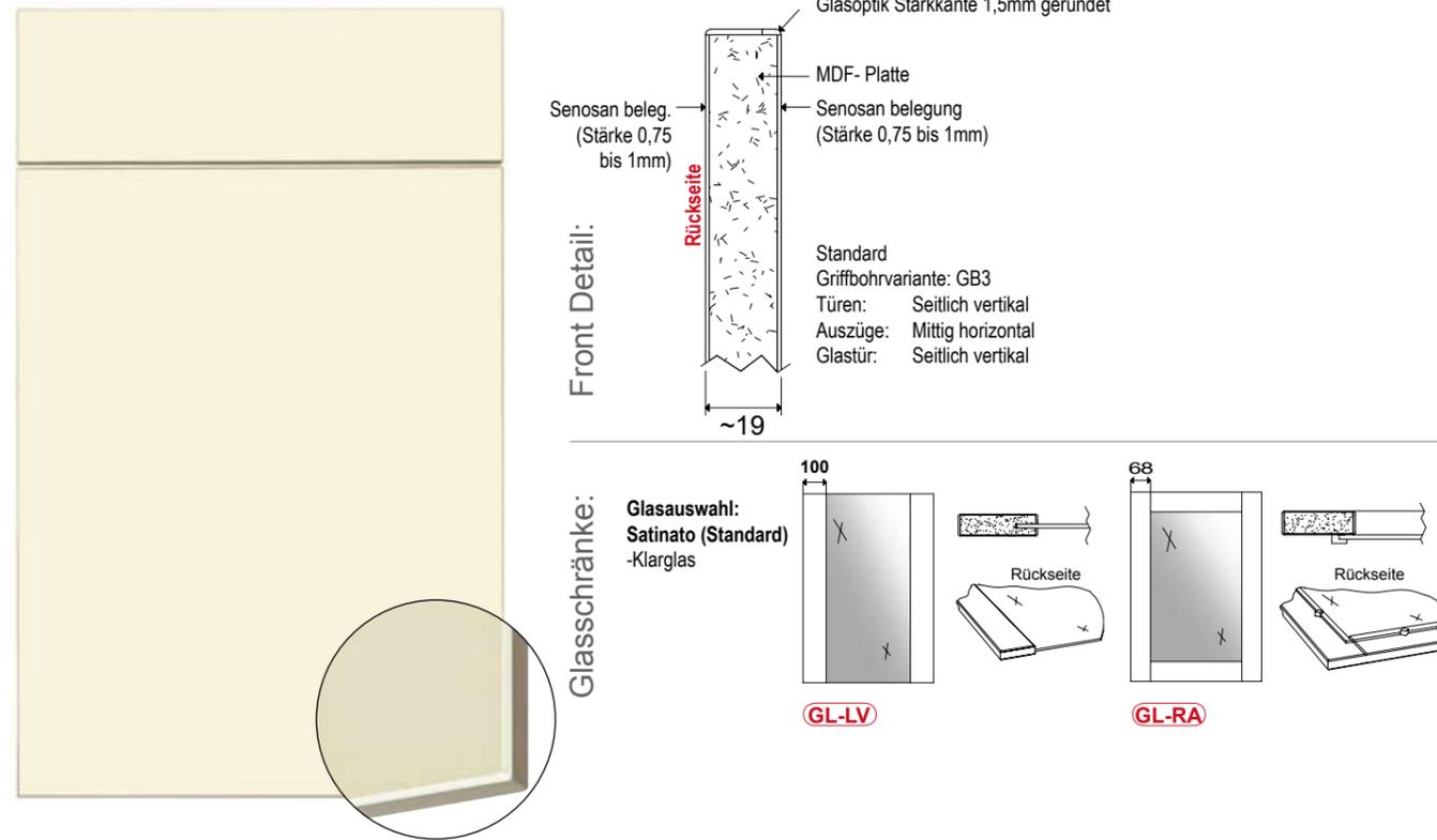
MDF-Platte mit beidseitiger Senosan-Belegung. 4-seitig mit 3D-Glaskoptik Starkkante, allseits gerundet.
