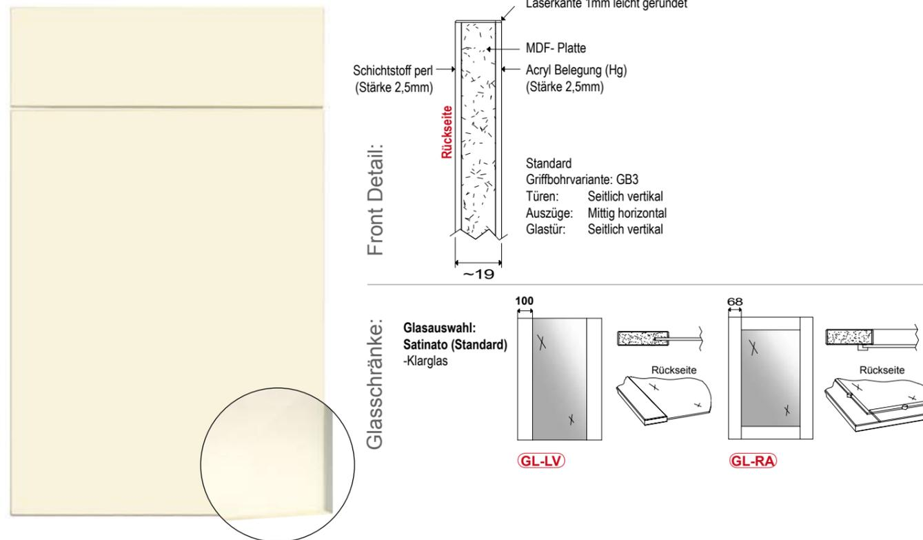
MDF-Platte mit 2,5mm Acrylglas-Belegung (Hg) auf der Vorderseite, Rückseite mit Laminat (perl). 4-seitig mit farbgleicher Laserkante, allseits leicht gerundet.
