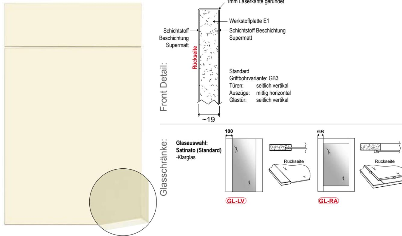
19mm E1 Werkstoffplatte mit beidseitiger Nanotech Schichtstoffbelegung. 4-seitig mit farbgleicher Laserkante, allseits leicht gerundet.
