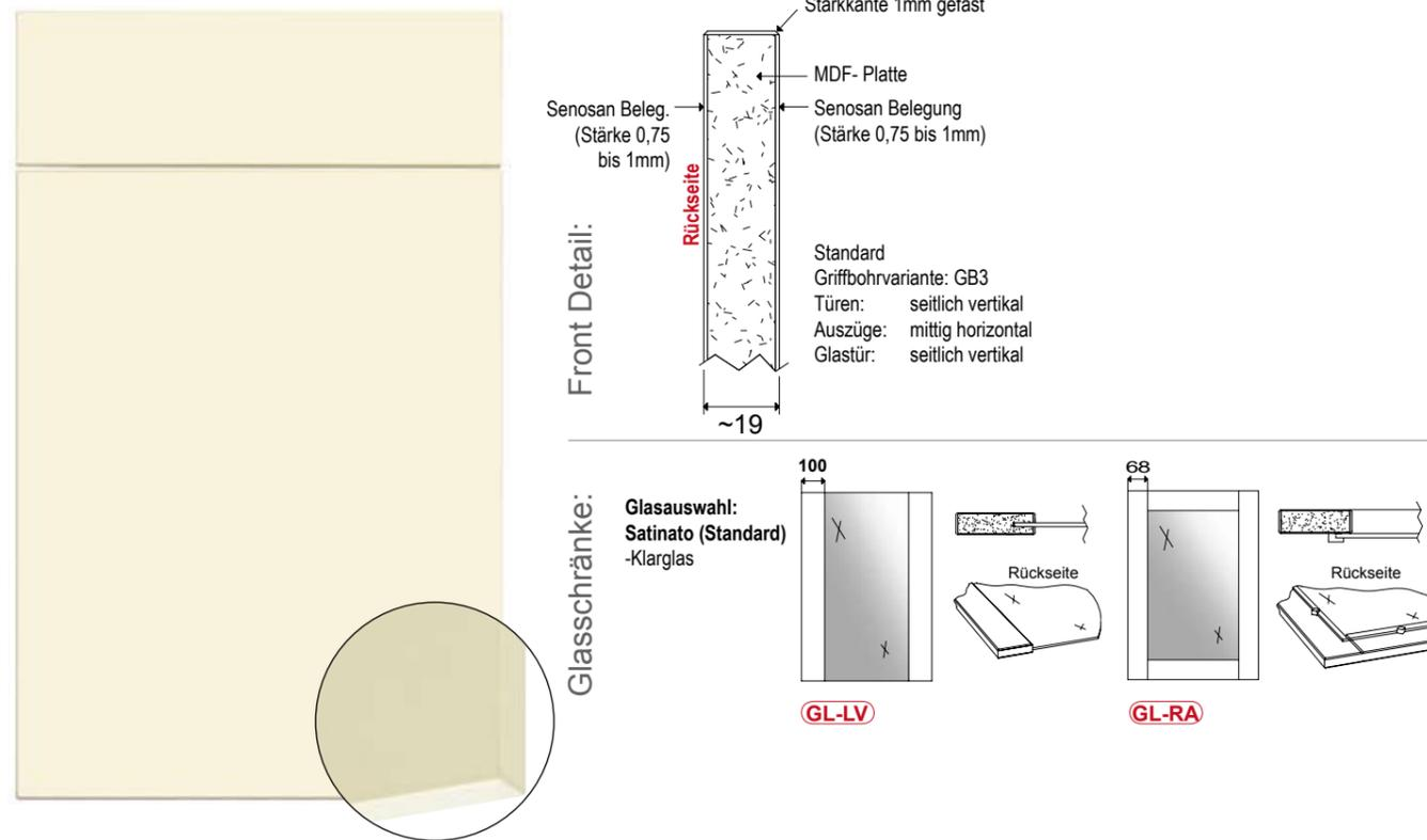
MDF-Platte mit beidseitiger Senosan-Belegung. 4-seitig mit farbgleicher Senosankante, allseits gefast.
