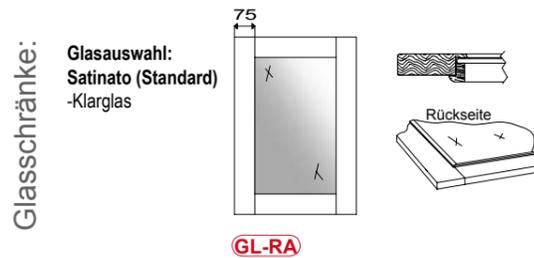
20mm Massivholz Rahmentür mit furnierter Füllung,
