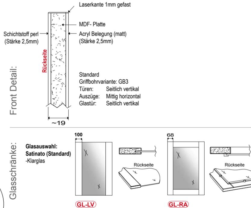
MDF-Platte mit 2,5mm Acrylglas-Belegung (matt) auf der Vorderseite, Rückseite mit Laminat (perl). 4-seitig mit farbgleicher Laserkante, allseits gefast.
