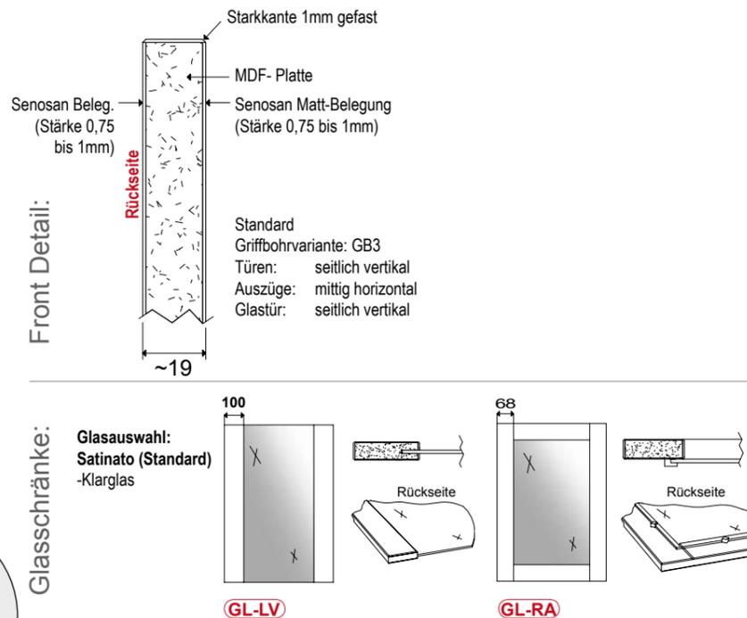
MDF-Platte mit beidseitiger Senosan-matt-Belegung. 4-seitig mit farbgleicher Senosankante, allseits gefast.
