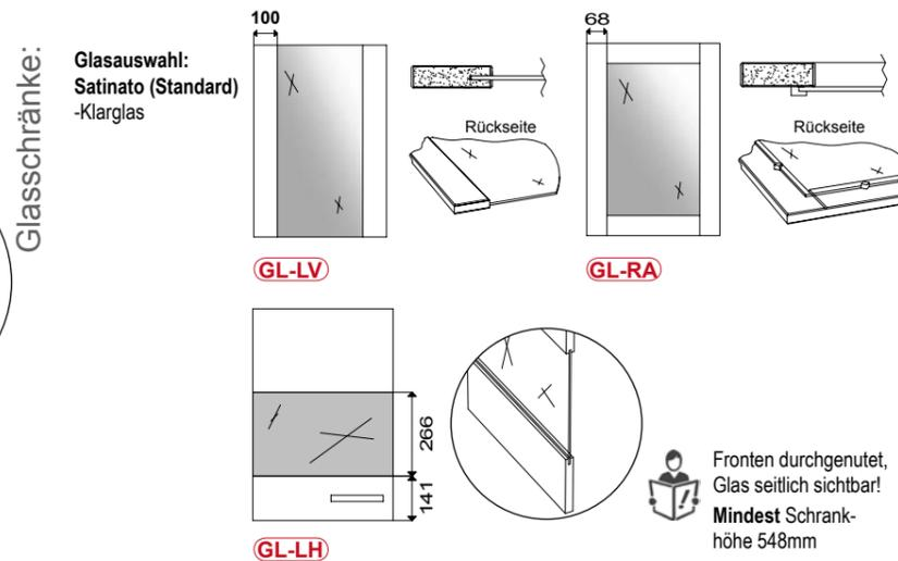
19mm E1 Werkstoffplatte mit beidseitiger Melaminharzbeschichtung (Repro Nachbildung). 4-seitig 0,8mm Starkkante nach Wahl. **Maserung quer.**
